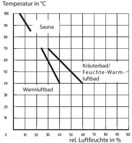
Die im Display angezeigte Feuchteintensität entspricht der zeitproportionalen Verdampferleistungseinstellung. Im Display wird daher nicht die relative Luftfeuchtigkeit vorgewählt bzw. angezeigt, sondern die Einschalthäufigkeit des Verdampfers in Prozent. Die Graphik soll dies verdeutlichen.
