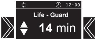
Nach Ablauf der „Life - Guard“ - Zeit wird der Saunaofen abgeschaltet und die eingestellte „Life - Guard“ - Zeit blinkt
